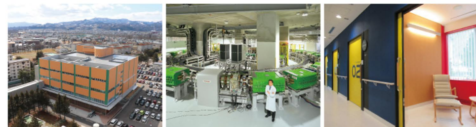
【写真左】「山形大学医学部東日本重粒子センター」の建設計画は2004年に始動。翌年には国立大学初の独立した「医学部がんセンター」の認可・設立に至っている。【写真中】重粒子線治療でがんを照射する。炭素の原子核を光の70%ほどの速度にする大型の加速器（シンクロトロン）と副学長の根本建二理事。【写真右】治療待機室エリアはリラックスして過ごせるよう全て個室になっているほか、緊張感を抑える明るい配色が施されている。
