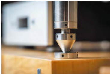
スパイク(足の先端)をスパイク受けに嵌め込むように押し込むことで、すべての接点が60°の円錐と60°のすり鉢の面と面で接触するラジアルサポート構造。「スパイク構造体および該構造体を用いたラック」として特許を取得している。
