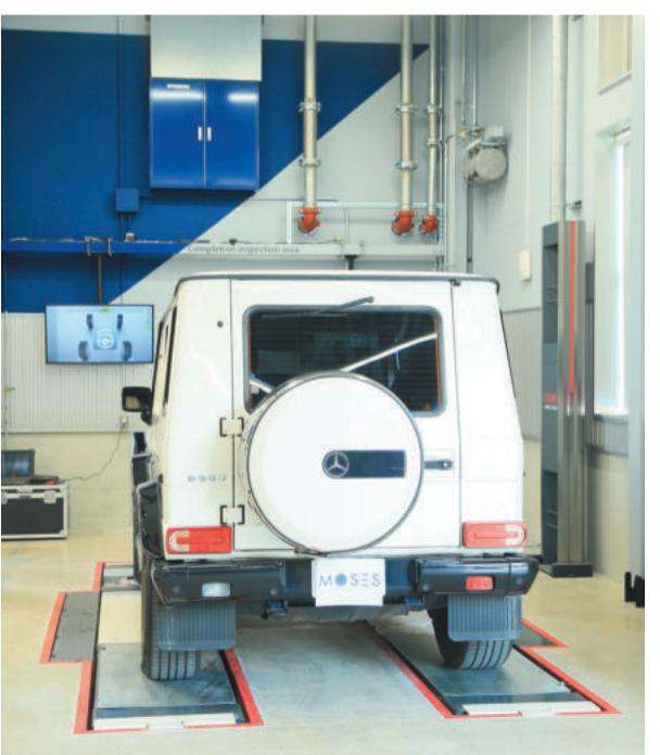
月160台～200台の乗用車を入庫しているが、そのうち輸入車が約半数を占めている。メルセデス、ランボルギニ、フェラーリなど、メーカーはさまざまだが、輸入車も全メーカーのエーミング作業(先進安全システムが正しく動作するための校正作業)に対応しているため、安心して整備・修理を任せることができる。
