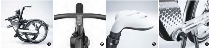
①工具なし、2ステップでここまで小さくなる。②システム一体型のシンプルで分かりやすい液晶ディスプレイ ③デザインにこだわったサドルもハンドルも一体型。特にサドルは盗難の心配もなし。④チェーンレスの便利さは、一度慣れるともう戻れないレベル。
