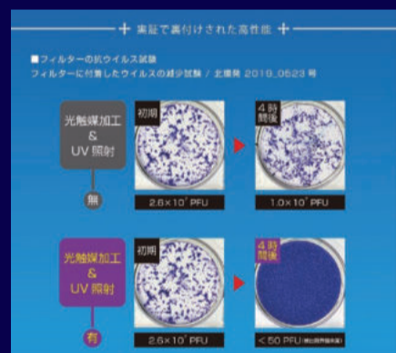
[左図]MC-T101のフィルター構造 [右図]試験機関:一般財団法人北里環境科学センター 試験ウイルス:付着した1種類のウイルス 試験方法:光触媒試験法(JIS R 1706:2013)を参考に実施 ウイルス定量法:ブランク法による感染価測定 ※写真の白い部分は、ウイルスが増殖して細胞が死んでいる状態です。
