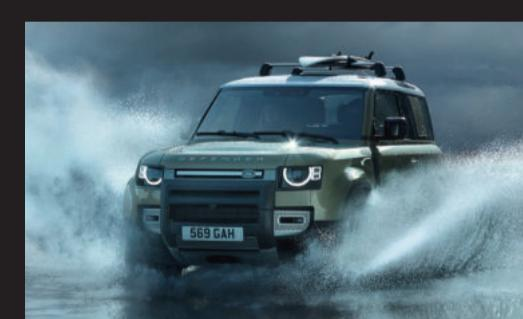
最大渡河水深は900mmを実現。最新テクノロジーを搭載しており、3Dサラウンドカメラ等が水深の把握をサポート。他に、フルタイムでコネクティビティが可能な新世代型のインフォテインメントシステムの搭載をはじめ、10インチのタッチスクリーンでは、Apple CarPlayやAndroid Autoにも対応する。写真はショートボディの「90」。
