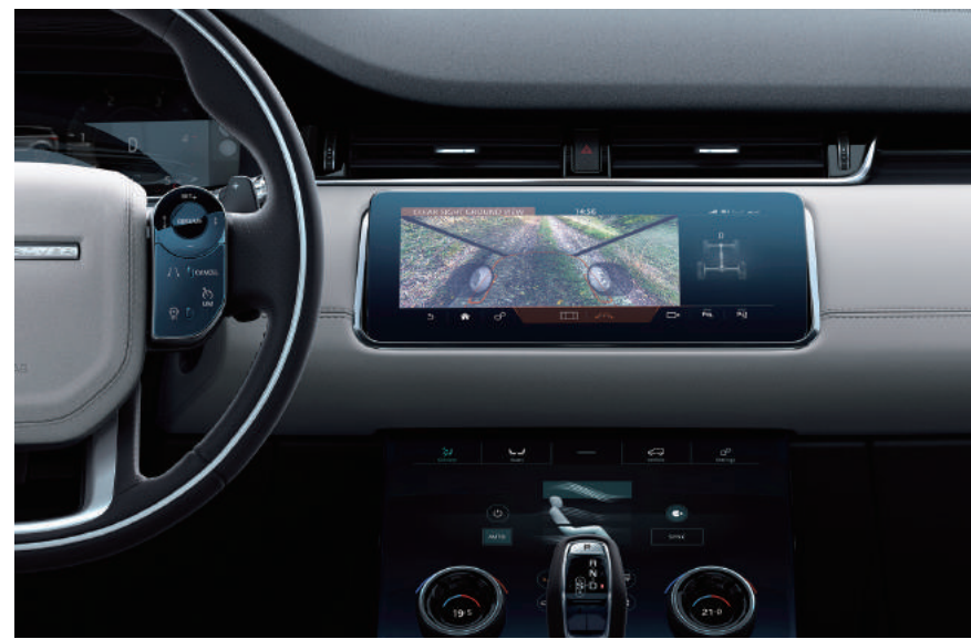
ボンネットが無いように、フロント下180度の視界を確保する最新機能「クリアサイトグラウンドビュー」を搭載。段差のある中央分離帯や障害のある路面の状況走行中に確認することができる。
