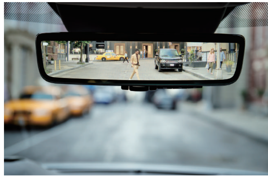
ランドローバー初採用のテクノロジー「クリアサイトルームミラー」は車体に装備したカメラによって、後方映像をルームミラーに映し出す。ラゲッジスペースに荷物が積まれていても後方をはっきりと確認することができる。
