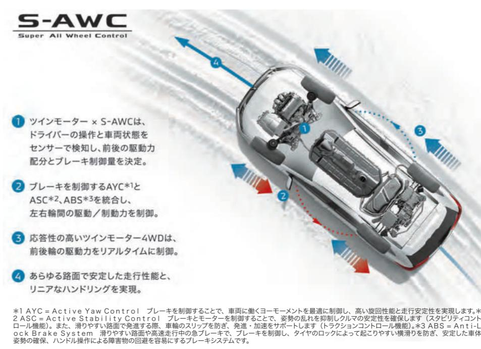
\*1 AYC = Active Yaw Control ブレーキを制御することで、車両に働くヨーモーメントを最適に制御し、高い旋回性能と走行安定性を実現します。\*2 ASC = Active Stability Control ブレーキとモーターを制御することで、姿勢の乱れを抑制しクルマの安定性を確保します（スタビリティコントロール機能）。また、滑りやすい路面で発生する際、車輪のスリップを防ぎ、発進・加速をサポートします（トラクションコントロール機能）。\*3 ABS = Anti-Lock Brake System 滑りやすい路面や高速走行中の緊急ブレーキ時、ブレーキを制御し、タイヤのロックによって起こりやすい横滑りを防ぎ、安定した車体姿勢の確保、ハンドル操作による障害物の回避を容易にするブレーキシステムです。
