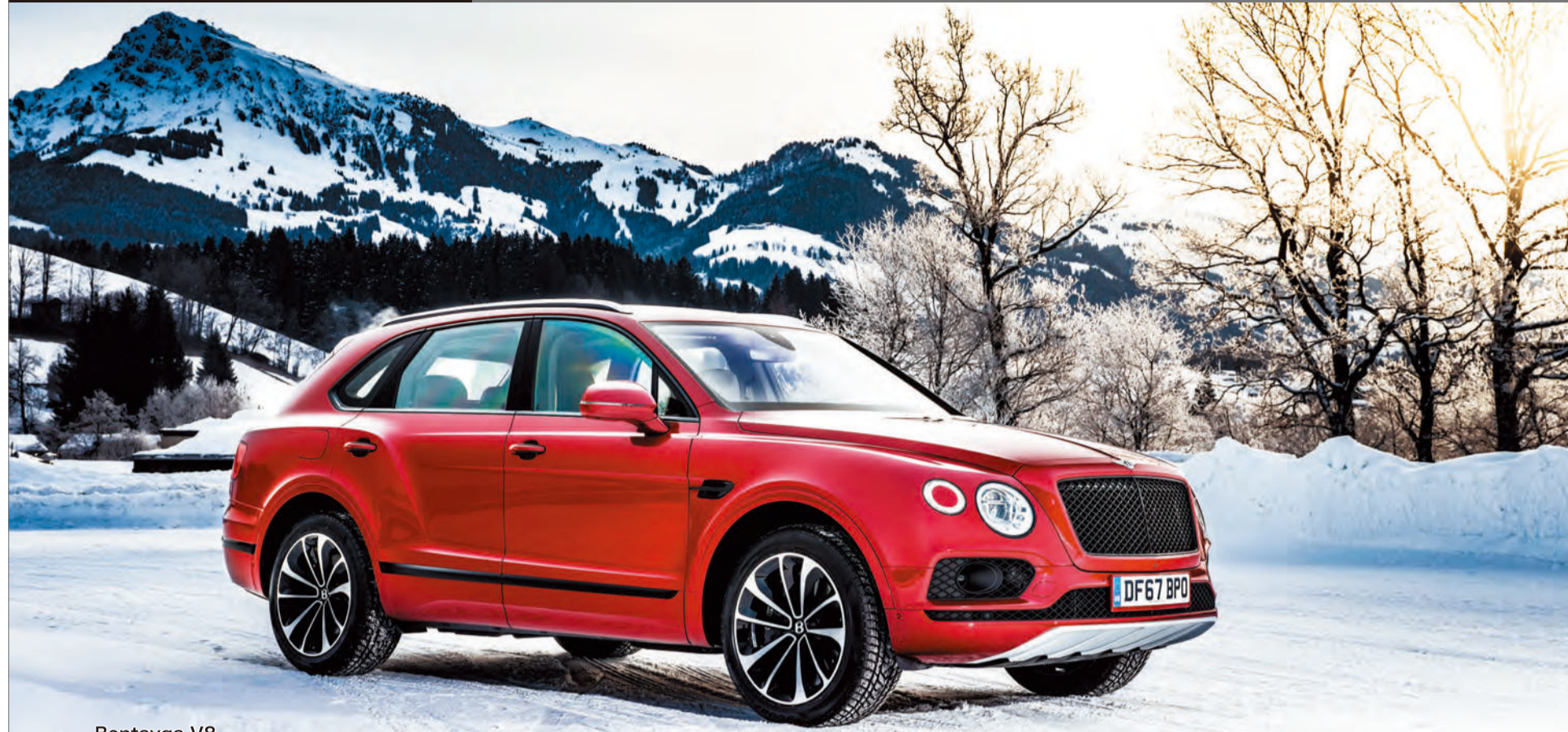
Bentayga V8 エンジン/4.0リッターV8ツインターボ 最高出力/550 PS @6,000rpm 最大トルク/770 Nm @1,960-4,500 rpm 駆動方式/8速オートマチック、フルタイム全輪駆動 全長/5150mm 全幅/1995mm 全高/1755mm 車両重量/2480kg 最高速度/290km/h 0-100 km/h/4.5秒 メーカー希望小売価格/¥19,946,000(税込)
