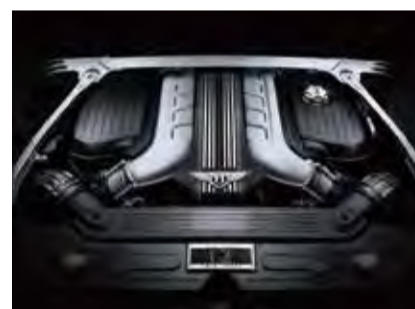
635馬力/900N・mと大幅なパワーアップを実現した6リッターW12 TSIツインターボエンジン。
