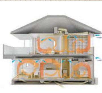
スマート・エアーズ (株式会社デンソー) トヨタホームオリジナルの全館空調システム。家の中の温度差を抑え、一年を通して快適な空気環境を提供。ヒートショックの軽減にも貢献。
