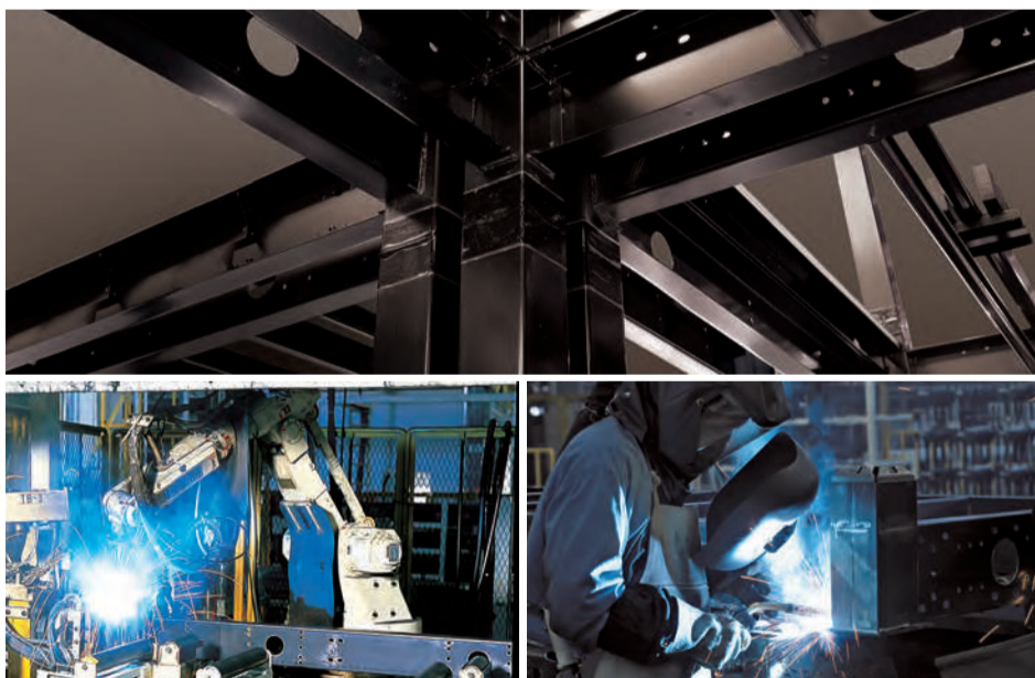
トヨタホームの工場は、機械と人間の協働の見本のようだ。「剛接合」とまで呼ばれる溶接技術も、正確無比なロボットと専門技能道場を通して腕を磨いた技能者の「適材適所」で実現されている。
