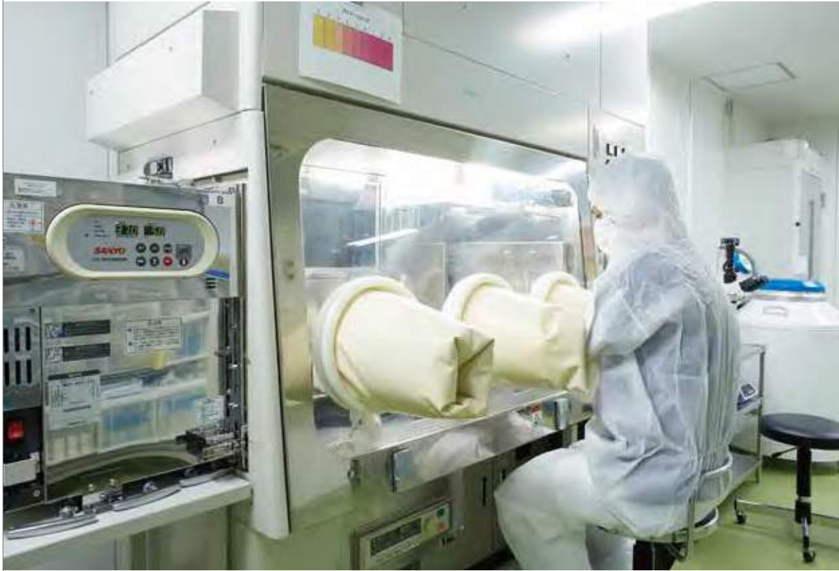
クリニック内のCPC内培養室。高度な空気清浄度で無菌状態を保つクリーンルームだ。
