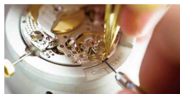
パワーリザーブ88時間(72時間の等時性確保、自動巻き(21,600振動))
