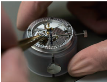
【左】コンプリケーションムーブメントの組立工程。カルティエはジュネーブにも工房を有している。 【右】上の写真の建物の2階が設計部門のオフィス。階下の製造部門とは常にコミュニケーションが取れる環境。 Photo by Masahiko Takeda
