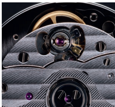
「クレドゥ カルティエ」のために新たに開発された自社製ムーブメント「1847-MC」
